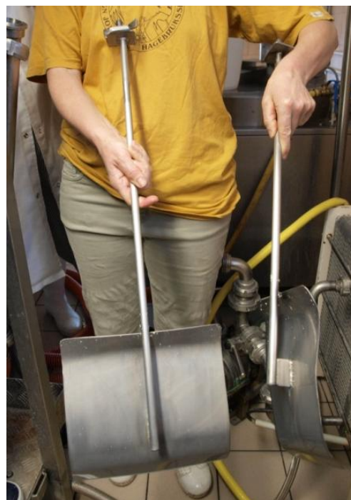
Figur 2 Spesiellaga røyverk til Rademakerakret
