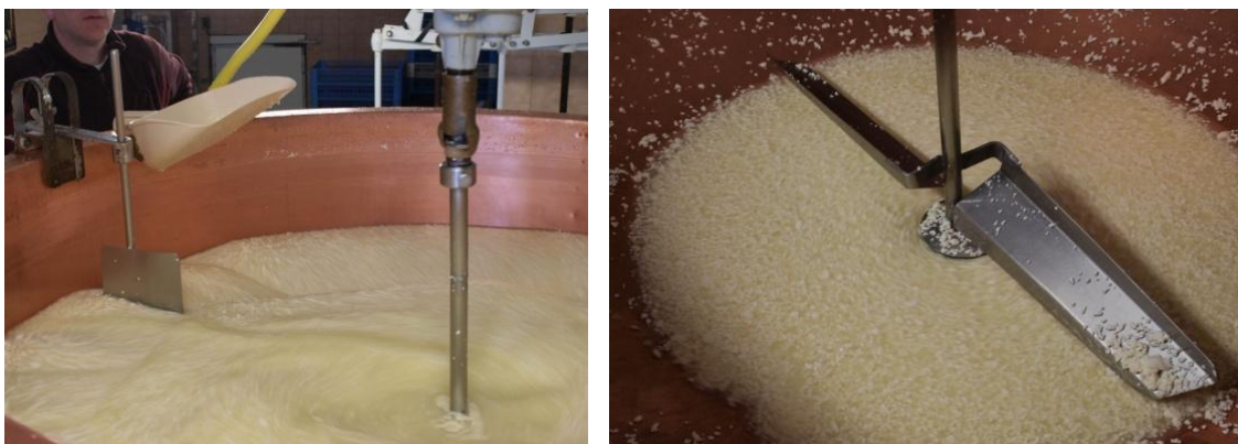
Figur 1 Comtéystekar av kopar med røyreverk som gjev god og jamn røring av ostemassen
